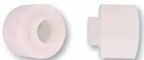
PE-13800-PF Jeu de 2 adaptateurs de montage de roulements Shimano Press Fit - à utiliser avec le presse-cuvettes DR-03500
