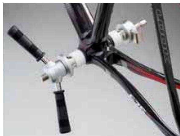
**PE-13500 Outil de montage et démontage de roulements pour pédaliers BB30**
