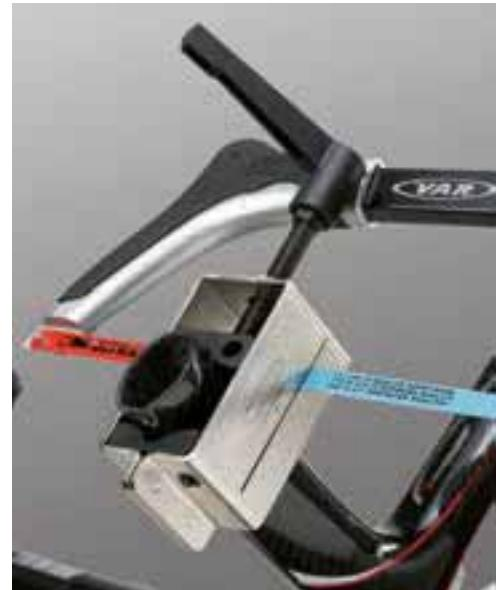
**FH-93100 Guide lame de scie réglable pour pivot de fourche**
