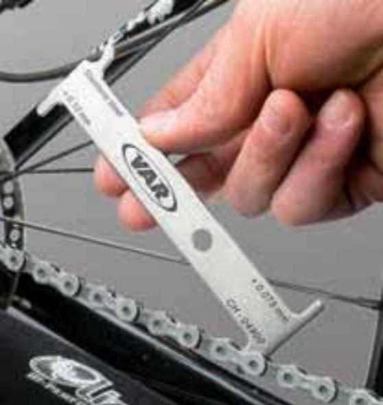
CH-04900-C Indicateur d'usure de chaîne
