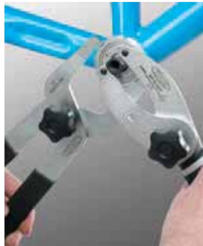
**BP-30200 Clé pour contre-écrou de boîtier de pédales**
